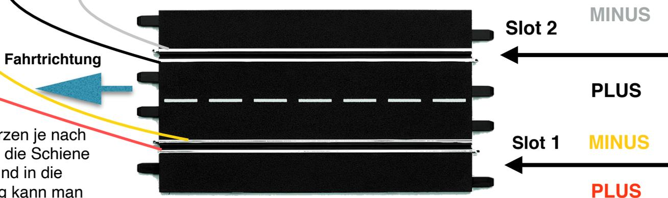
Zusatzeinspeisung in der Mitte oder in der Länge kürzen je nach Bedarf. Die Enden der Kabeln mit den Clips unten in die Schiene (Leiter) stecken. Die Enden **ohne** Clips abisolieren und in die Wagoklemmen stecken. Von den Wagoklemmen weg kann man natürlich mehrere Schienen anspeisen. **Immer** auf die Fahrtrichtungen und Verpolung achten! Die Kabelfarben sind natürlich frei wählbar.
